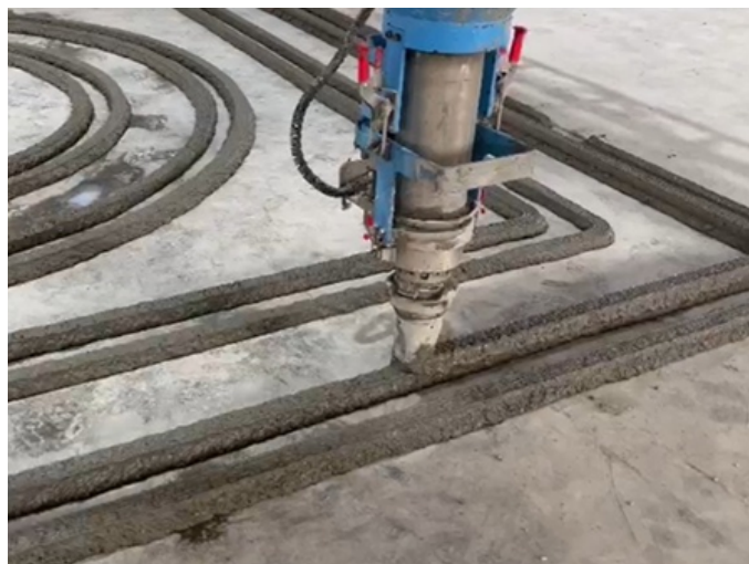
Peralatan yang digunakan dan Concrete Printing yang dihasilkan
