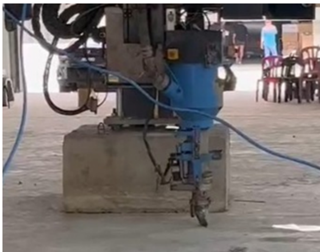
Peralatan yang digunakan dan Concrete Printing yang dihasilkan
