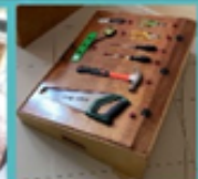
Bot (sensor mengesan ketiadaan serta posisi perletakan peralatan tangan) Kos = RM132.50
